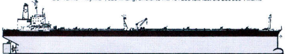
Die drei Schiffe der «L»-Klasse, Flaggschiffe der Deutschen Shell Flotte, tragen bei 351 m Länge 313 000 t
